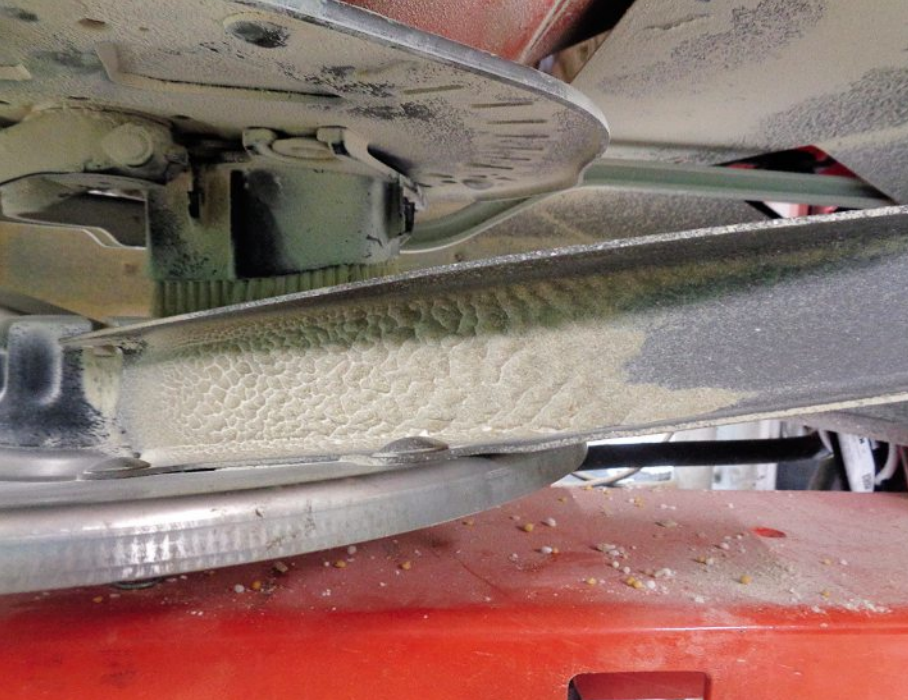
Verklebte Streuschaufeln führen zu einer ungleichmäßigen Düngerverteilung. Bei Importharnstoffen mit nachträglich aufgebrachtem Ureaseinhibitor tritt dieses Phänomen verstärkt auf.
