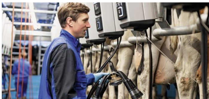
Nur das Ansetzen des Melkzeuges muss der Landwirt beim MA von DeLaval noch manuell übernehmen.
