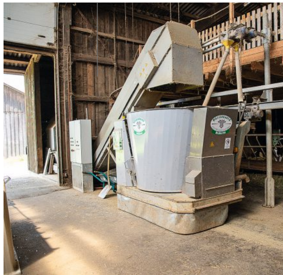
△ Der Fütterungsroboter bereitet 10-mal am Tag frisches Futter.
